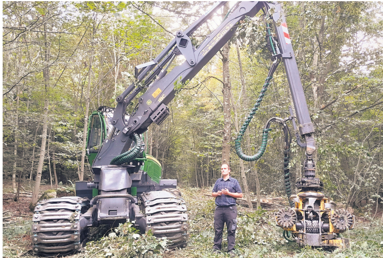
Maschinen wie diesen Vollernter wird man an der «megaNatur» im Einsatz erleben können. Dieser ist mit Moorbändern ausgestattet, um die Bodenverdichtung zu vermindern. Auf dem Bild erklärt Tobias Wiss dessen Funktionsweise.
